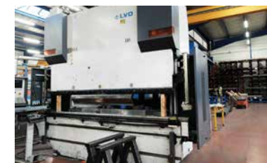
5 presses plieuses de 3 m à 7,5 m. Jusqu'à 400 t. Système de programmation à distance avec notamment le logiciel BYSOFT.
