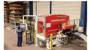
Poinçonneuse grande dimension 7,5 m x 2 m. Poinçonnage jusqu'à 6 mm. Chargement et déchargement automatique.
