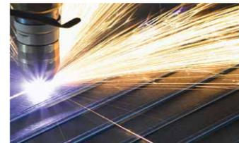
10 m x 2,5 m x 80 mm de capacité. Système XPR 300A qui surpasse la HD en qualité et en vitesse. 15% supérieure. Précision +/- 0,1 mm sur 10 m. Système de découpe tube jusque 400 mm de diamètre. Tête 5 axes permettant notamment de faire des chanfreins et supprimer la dépouille.
