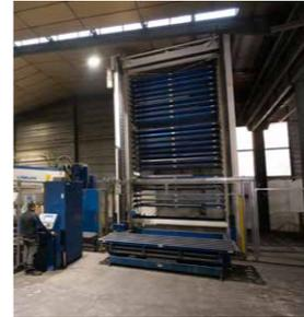
Lasers TRUMPF – 4000x2000 avec Lift Master et 3000x1500 avec tour de stockage de 80t qui alimente le laser en automatique. Capacité 4 000 x 2 000, jusqu'à 25 mm d'épaisseur, chargement et déchargement automatique.
